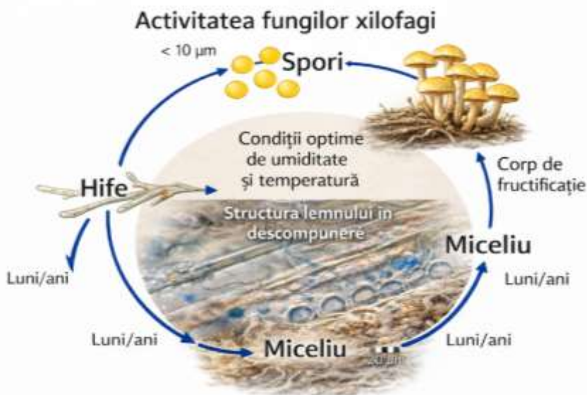
Рис. 17 Схема життєдіяльності ксилофагних грибів. Концепція, викладена доктором філософії Йоханом Маттссоном (Johan Mattsson), MYCOTEAM: www.mycoteam.no , у рамках «Міжнародного курсу з технологій консервації деревини», організованого в Норвегії Riksantikvaren, NTNU та ICCROM
